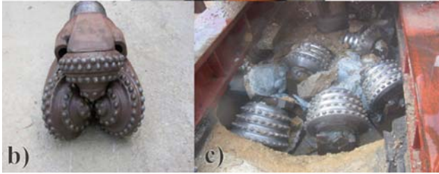
Şekil 2. a) BDM, b) kılavuz delgi matkabı, c) raybalama kafası.
